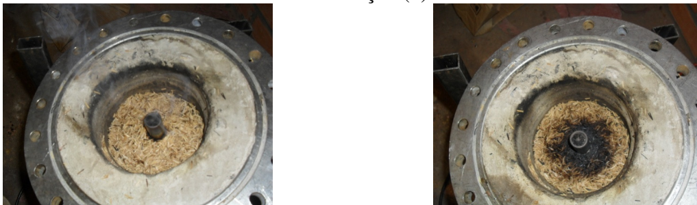
Figura 3: Biomassa após uma hora de carbonização (a), biomassa após três horas de carbonização (b).
