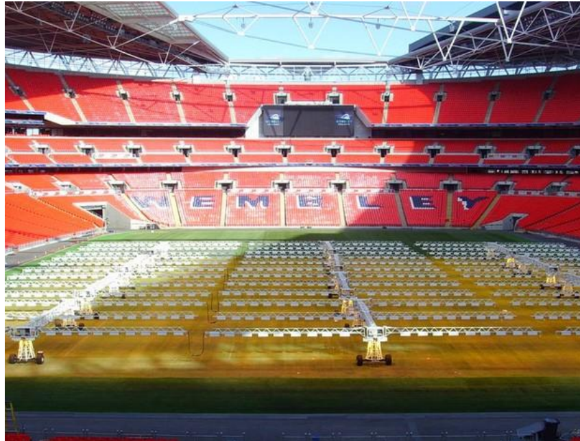
Imagem 3 - Com pouca incidência de luz do sol, gramado de Wembley precisa de luz artificial.
