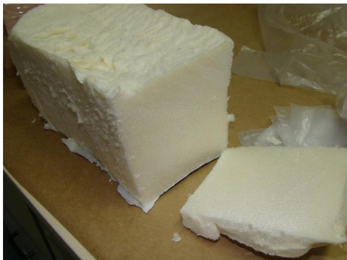
Figura 2. Bloco de PUR proporção 1:1 após tempo de cura
