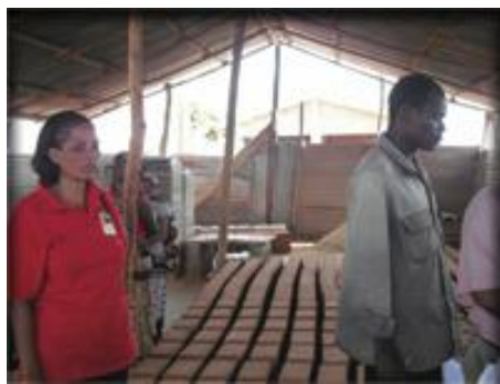
Figura 01: CTN – Produção local de blocos de solo-cimento (Dezembro/2010)
