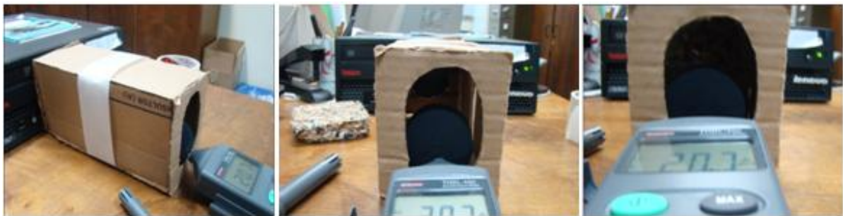
Figura 4 - Isolamento térmico: a) Esquema e b) Imagens do ensaio.
