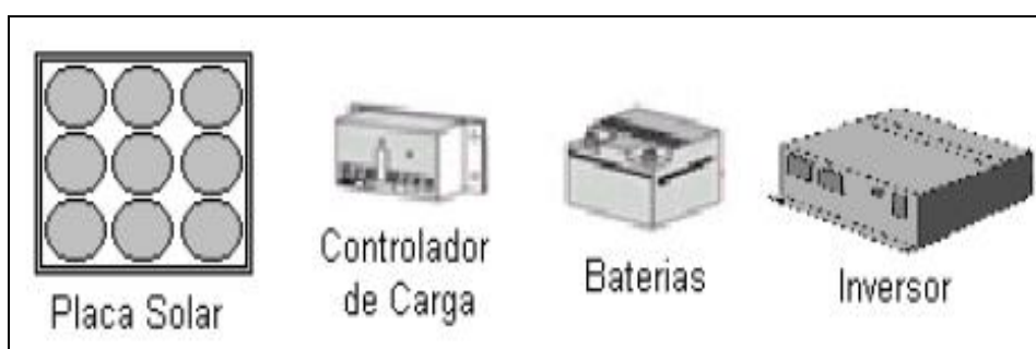
Figura 2 – Sistema completo de geração fotovoltaica de energia
