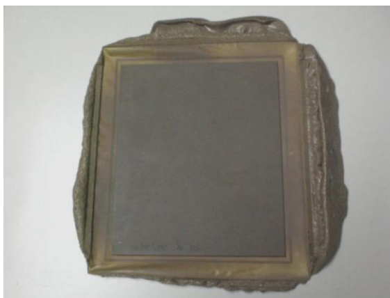
Figura 1 – Lençol moldado por compressão térmica.
