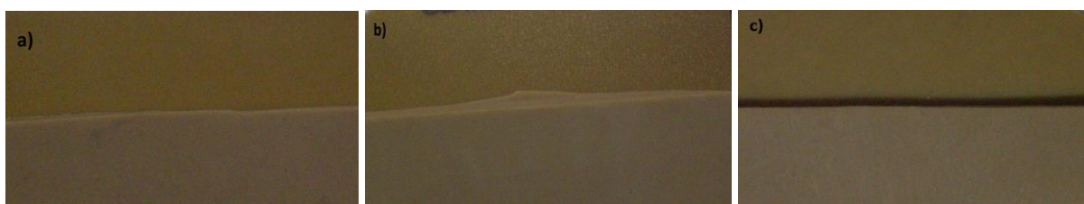
Figura 4 – Imagens comparativas das amostras antes (parte inferior) e o depois (parte superior) da exposição ao intemperismo: a) NR Cloisite 20A, b) NR Cloisite \text{Na}^+ e c) NR Pura.
