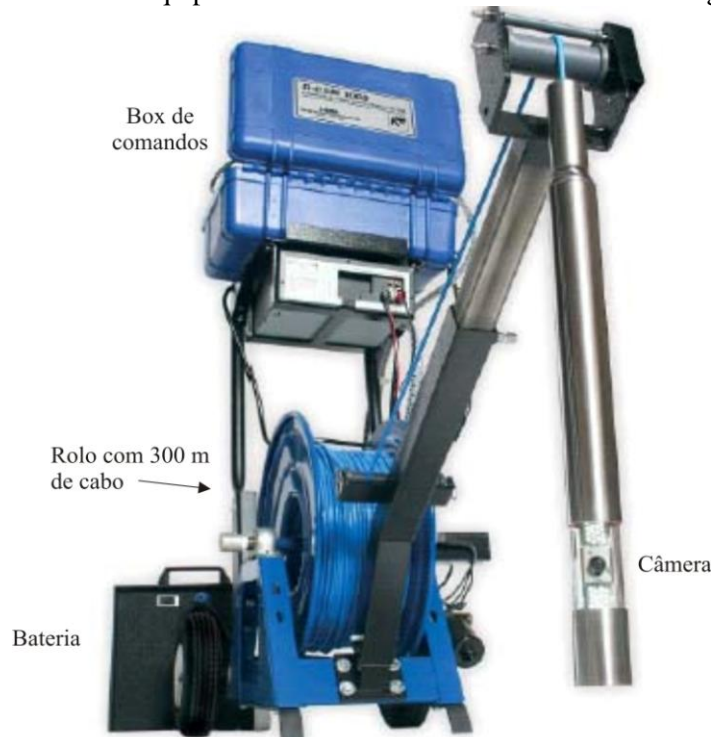
Figura 1 – Visão Geral do Equipamento R-1000 Dual Cam da Laval Underground Surveys.
